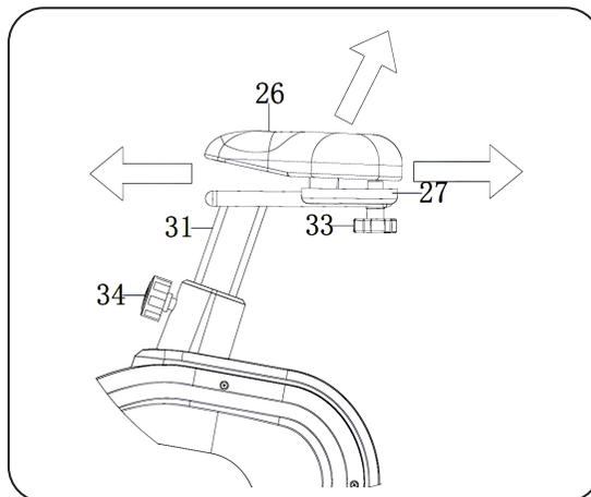
Поверните ручку (34) против часовой стрелки, чтобы отрегулировать высоту в соответствии с отверстиями на опоре сиденья (31). Поверните ручку (33) против часовой стрелки, чтобы отрегулировать расстояние по горизонтали в соответствии со стрелками на пластине сиденья (27).
