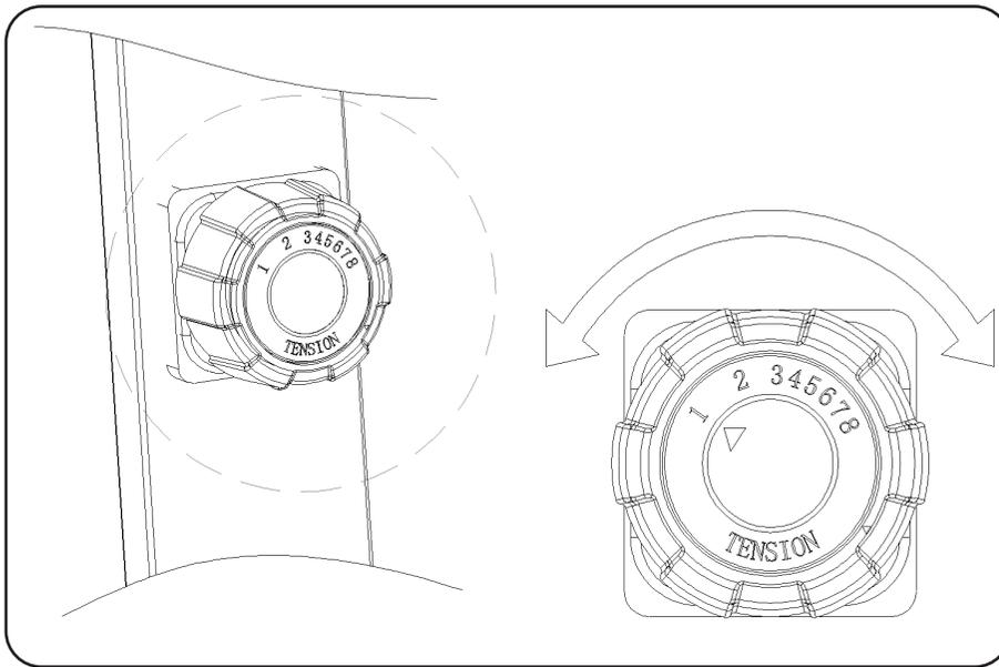
Поверните ручку регулировки (10) по часовой стрелке, чтобы увеличить уровень нагрузки, поверните ручку регулировки против часовой стрелки, чтобы уменьшить уровень нагрузки. Уровень 1 — самый низкий, уровень 12 — самый высокий.
